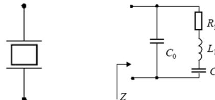
Otpornost  $R_1$  je vrlo mala, tako da se može smatrati da se kristal kvarca ponaša kao čisto reaktivni dvopol, odnosno kao idealno oscilatorno kolo.
