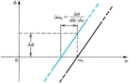
**Stabilnost frekvencije zavisi od stabilnosti faze signala u povratnoj petlji, a ona zavisi od aktivnih i pasivnih elemenata u kolu i od otpornosti potrošača.**
